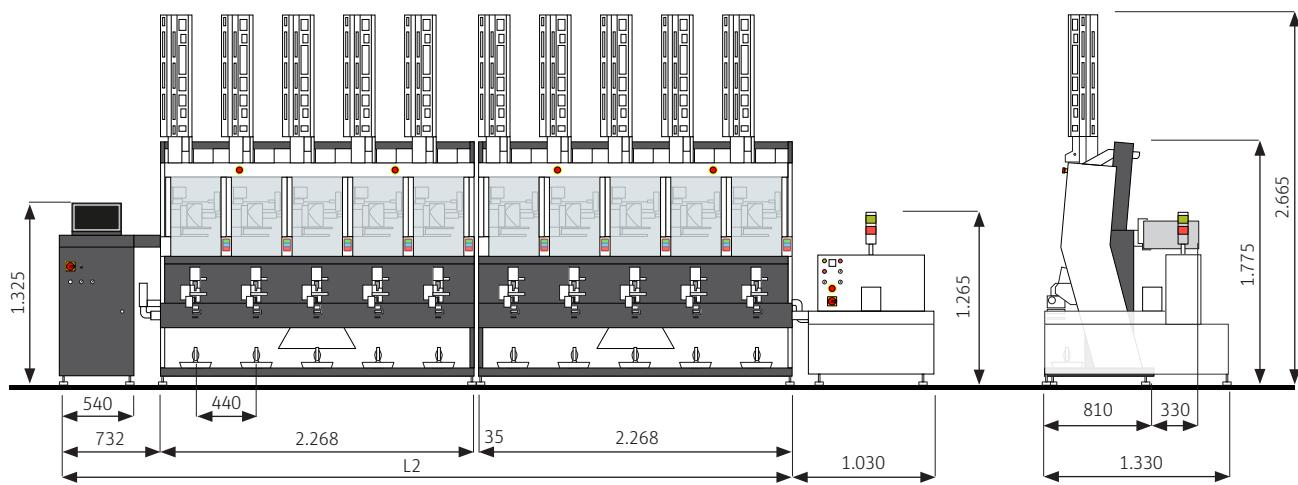
Silindir yüzeyinden soğuk yağlama sistemi PU11
